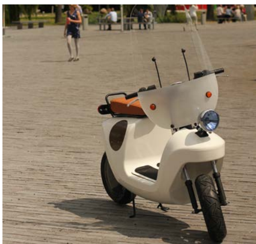
Prototype van 's werelds meest duurzame elektrische scooter met een volledig dragende constructie van bio-composiet.
